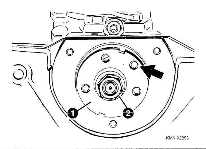
CLAMPING FUEL-INJECTION PUMP IN POSITION
